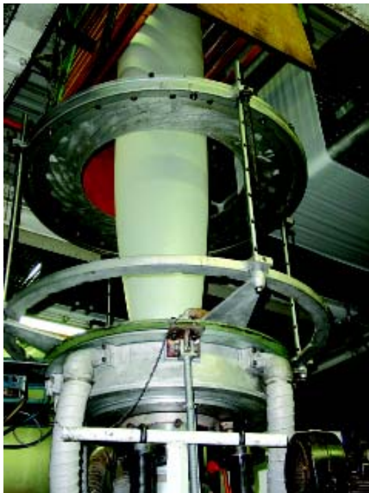
Verarbeitung des biologisch abbaubaren Werkstoffs auf einer Blasfolienanlage
