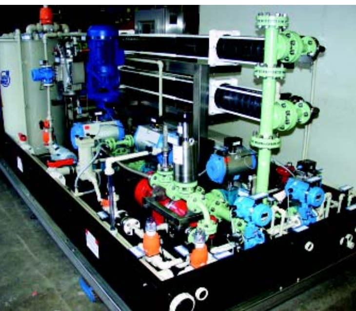
Ganz schön beweglich – mobile Membrananlagen gewinnen flexibel genau da die Säuren zurück, wo sie anfallen
