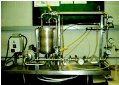
Cross Flow Membranmodul zur Abwasserbehandlung
