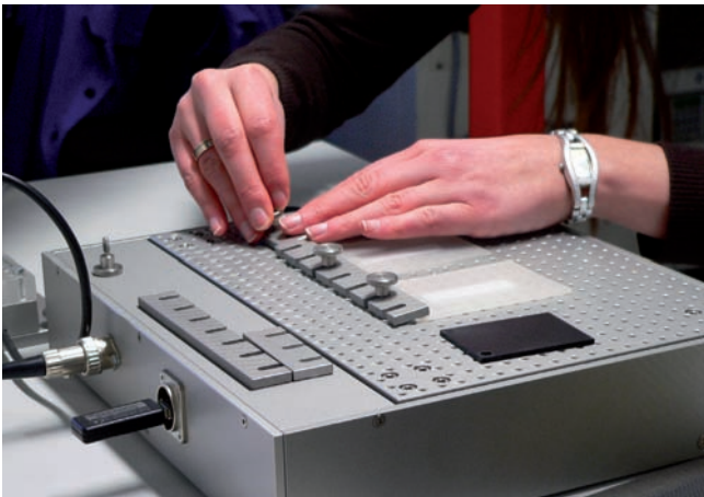
Auf der Kraftmessplatte werden die unterschiedlichen Materialien für die Analyse befestigt.
