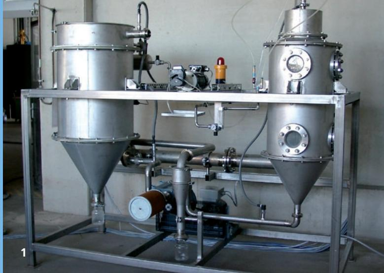
1 *Sprühtrockner im Kleintechnikmaßstab mit einer Verdampfungsleistung von 6 l/h.*
