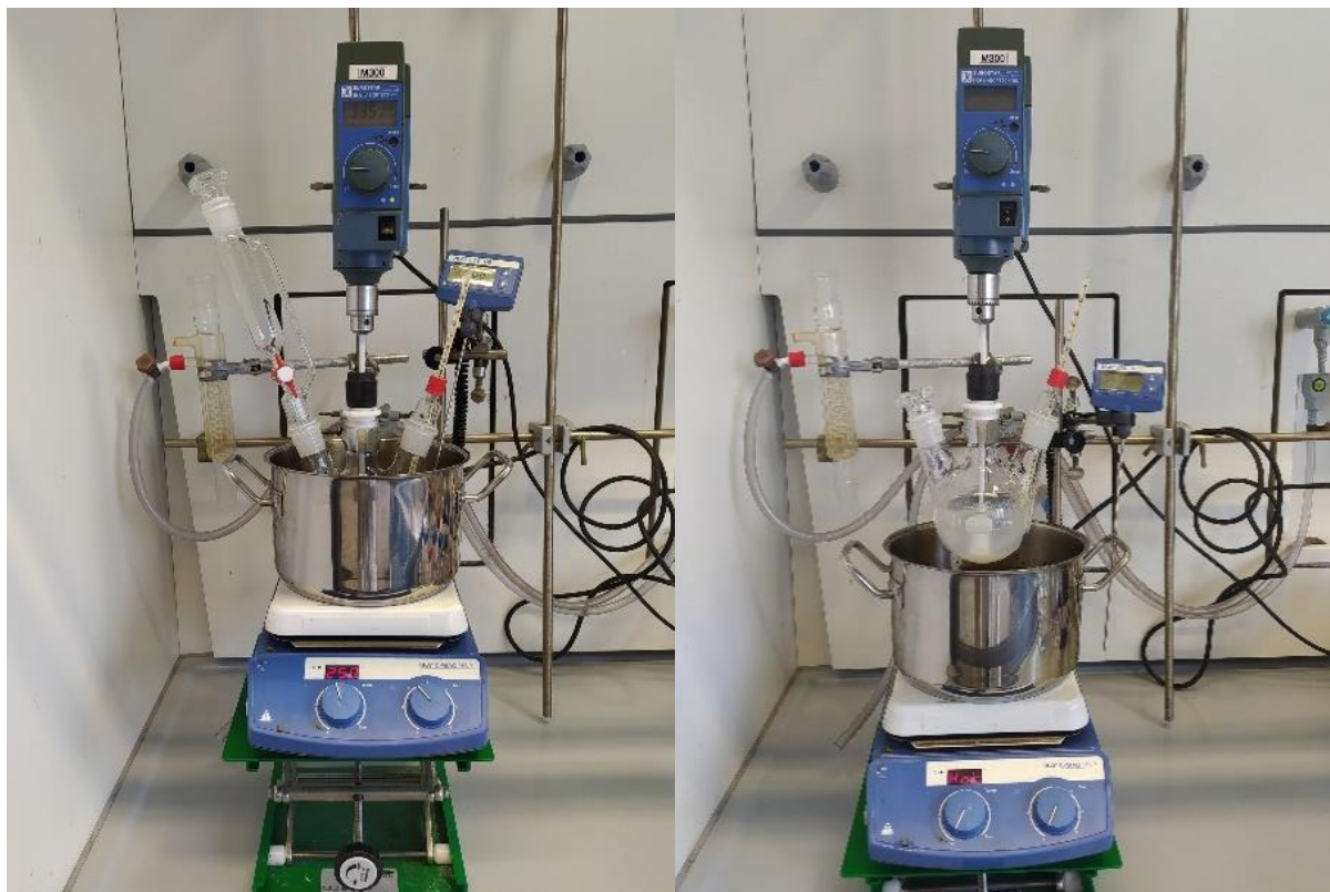
Abbildung a-1: 500 mL-Syntheseanlage mit 500 mL-Dreihalskolben, Ölbad, Rührplatte, KPG-Rührer, Tropftrichter, Thermometer.
