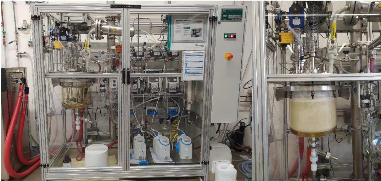
Abbildung b-2: 20 L-Syntheseanlage: 20 L-doppelwandiger Glasreaktor, Dosierpumpen, integrierte Rührereinheit und Zerstäuber, Öl-Thermostat zur Beheizung.
