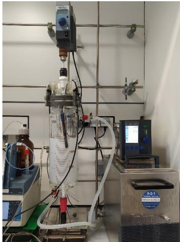
Abbildung b-1: 2 L Syntheseanlage: 2 L-doppelwandiger Glasreaktor, Thermostat für die Beheizung, pH-Elektrode, Dosierpumpe, KPG-Rührer.
